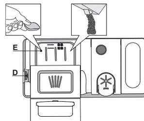
1. При измерване на препарата првете справка със споменатата информация по-горе, за да добавите подходящо количество. в дозатора **E** има индикатори, за да помогнат за дозирането на миялния препарат.
