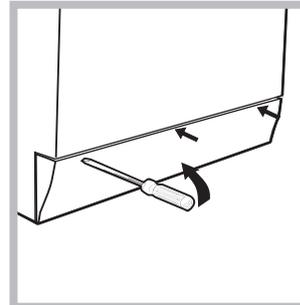
1. Nehmen Sie die Abdeckung an der Gerätefront ab, indem Sie sie an der Mitte und an den Seiten mit einem Schraubendreher aufhebeln.
