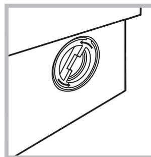
2. Deckel der Ablaufpumpe durch Drehen nach links abschrauben: es ist ganz normal, wenn etwas Wasser austritt.
