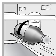
Vak voor **FLESSEN/BLIKJES:** voor het horizontaal opbergen van een fles of meerdere blikjes (zie *afbeeldingen*). Wanneer u dit gedeelte niet gebruikt, dient u het deksel af te sluiten om de ruimte in het koelgedeelte te vergroten.
