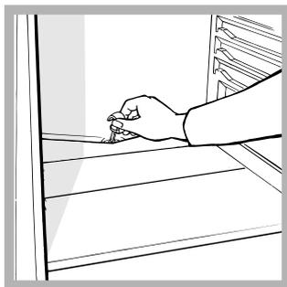
apposito foro di scarico (vedi figura) dove il calore prodotto dal compressore la fa evaporare.
