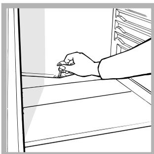
produite par le compresseur la fait évaporer. Il vous suffit de nettoyer périodiquement le trou d'évacuation pour permettre à l'eau de s'écouler normalement.
