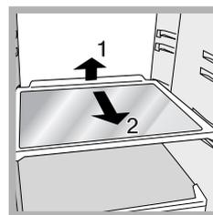
**DRAAGPLATEAUS:** plateaus of roosters. Deze kunnen dankzij de speciale gleuven worden verwijderd of in hoogte geregeld (zie *afbeelding*), voor het invoeren van grote verpakkingen of etenswaren. Het is niet noodzakelijk het draagplateau
