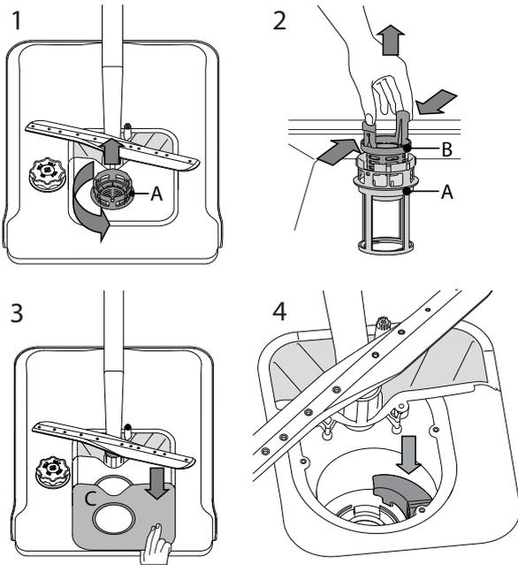
Nakon čišćenja filtera, ponovo postavite sklop filtera i pravilno ih pričvrstite na mesto; ovo je neophodno za efikasan rad mašine za pranje sudova.
