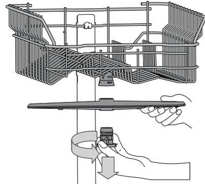
Pour enlever le bras d'aspersion supérieur, tournez l'anneau de verrouillage en plastique dans le sens antihoraire. Le bras d'aspersion supérieur doit être replacé de façon que le côté avec le plus grand nombre de trous est placé vers le haut.
