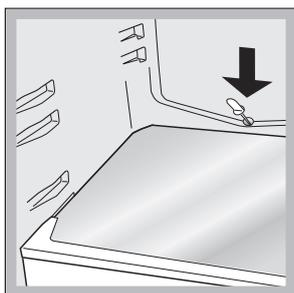
czynnością jaką należy wykonać co jakiś czas, to wyczyszczenie otworu odpływowego tak, aby woda mogła swobodnie wyciekać.
