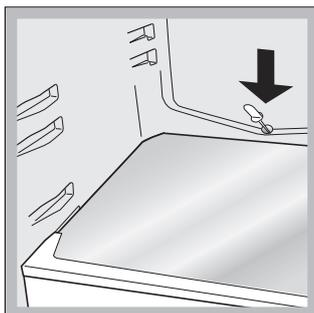
un orificiu de evacuare (vezi figura) de unde, cu ajutorul căldurii emenate, se evaporă. Singura intervenție pe care trebuie să o efectuați periodic constă în curățarea orificiului de evacuare pentru ca apa să poată circula fără obstacole.
