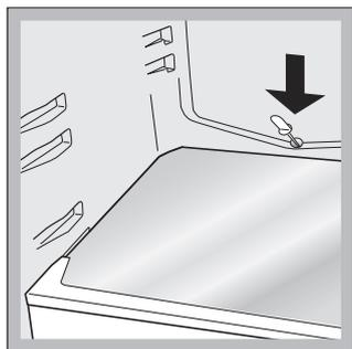
spočívá ve vyčištění vypouštěcího otvoru s cílem zabezpečit plynulý odvod vody.
