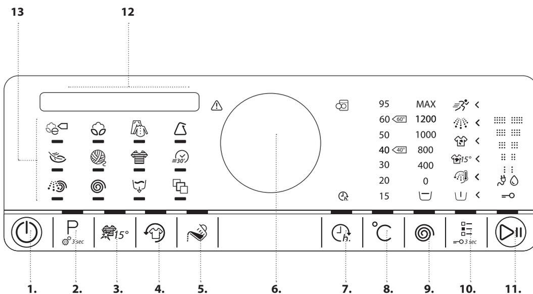
1. Botón Encendido/ Apagado (Reiniciar/Vaciar agua si se deja pulsado unos segundos)
