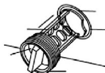
6. Fixez le couvercle en le vissant dans le sens contraire des aiguilles d'une montre.
