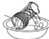
5. Remettez le filtre en place sur la sortie de la pompe.
