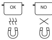
Folosiți numai oale și tigăi din material feromagnetic care sunt adecvate pentru utilizarea pe plite cu inducție:
