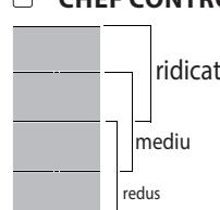
Zona flexibilă este împărțită în trei zone de gătit (consultați figura) activate la un nivel de putere prezentat (ridicat, mediu sau redus) în funcție de poziția oalei/tigăii: mutați oala/tigaia pe suprafață pentru a continua prepararea la temperaturi diferite fără să utilizați butoanele de comandă.
