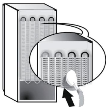
Aby bol zaručený nepretržitý a správny odtok rozmrazenej vody, čistite pravidelne vnútro odtokového kanálka na zadnej stene chladiaceho priestoru v blízkosti zásuvky na ovocie a zeleninu, pričom používajte dodaný nástroj.
