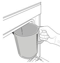
Po izboru funkcije „Ispuštanje vode“, sledite navedene radnje: Otvorite vrata i postavite veliki bokal ispod mlaznice za odvod vode koja se nalazi na dnu desno od table. Po započinjanju odvoda vode, držite bokal u položaju sve do završetka radnje. Prosečno trajanje ispuštanja sve vode je oko tri minuta.
