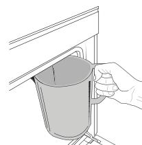
Kada odaberete funkciju „Ispuštanje“, pratite navedene radnje: Otvorite vrata i stavite široku posudu ispod mlaznice za ispuštanje u donjem desnom dijelu ploče. Nakon početka ispuštanja posudu u tom položaju držite sve dok zahvat ne završi. Potrebno je prosječno oko tri minute za ispuštanje cijelog punjenja.
