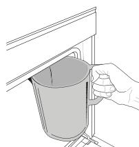
След като изберете функцията "Източване", следвайте посочените действия: Отворете вратичката и поставете голяма кана под дупката за източване, намираща се в долната дясна част на панела. Щом започне източването, придържайте каната
