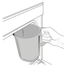
Ko izberete funkcijo „izčrpavanje“, sledite navedenim korakom: odprite vrata in pod odtočno šobo, ki se nahaja v spodnjem desnem delu plošče, postavite veliko posodo. Ko začnete z izčrpavanjem, posodo držite v tem položaju, dokler postopka ne zaključite. Postopek popolnega izčrpavanja traja približno tri minute.
