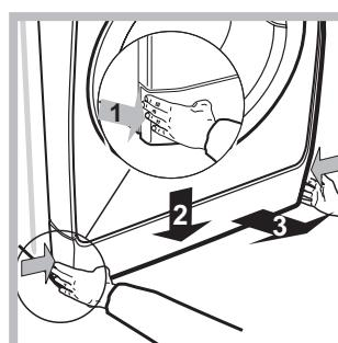
1. zdjąć panel z przedniej części urządzenia, naciskając go ku środkowi, a następnie popchnąć w dół z dwóch stron i wyjąć go (patrz rysunek).
