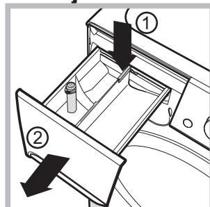
Çekmeceyi çıkarmak için, kola (1) basın ve çekmeceyi (2) dışarı doğru çekin (*şekile bakınız*). Musluk suyunun altında yıkayın, bu işlem sık sık tekrarlanmalıdır.
