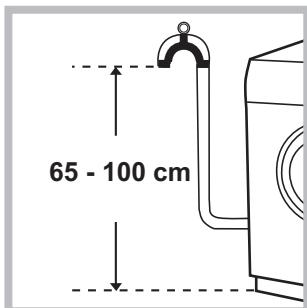
Conectați furtunul de evacuare, fără al îndoii, la o conductă sau la o gură de evacuare în zid, situată între 65 și 100 cm de pământ;
