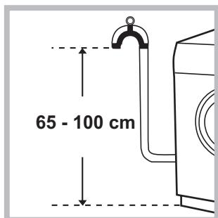
Podłączyć przewód odpływowego, nie zginając go, do rury ściekowej lub do otworu odpływowego w ścianie, które powinny się znajdować na wysokości od 65 do 100 cm od podłogi;
