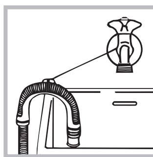
Buna alternatif olarak, makine ile birlikte verilen pis su borusunu musluğa (şekle bakınız) bağlayarak lavabo veya küvetin kenarına yerleştirin. Hortumun serbest kalan ucu suya daldırılmamalıdır.
