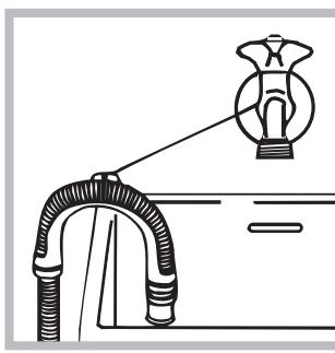
sau sprijinițil pe marginea unei chiuvete sau a unei căzi, legând elementul de ghidare la robinet (a se vedea figura). Capătul liber al furtunului de golire nu trebuie să rămână cufundat în apă.
