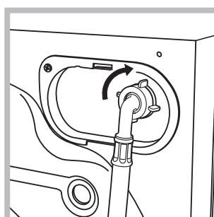
2. A vízbevezető cső csatlakoztatásához csavarozza a csövet a mosogép hátoldalán jobbra fent található vízbemeneti csonkra (lásd ábra).
