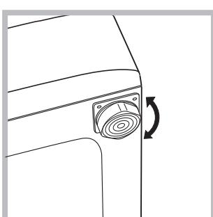
2. Se il pavimento non fosse perfettamente orizzontale, compensare le irregolarità svitando o avvitando i piedini anteriori (vedi figura); l'angolo di inclinazione, misurato sul piano di lavoro, non deve superare i 2°.
