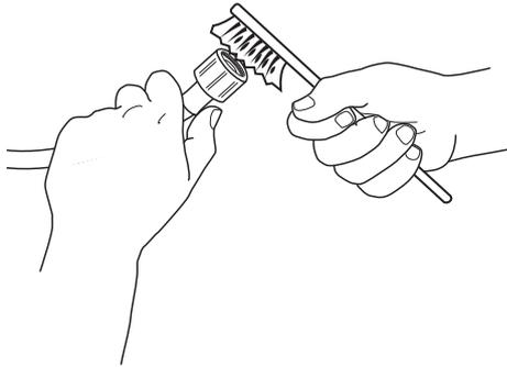
**3.** Em seguida, desaperte manualmente a mangueira da parte de trás da máquina de lavar e secar. Com a ajuda de alicates, remova o filtro da válvula localizado na parte de trás da máquina de lavar e secar e limpe-o.
