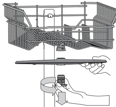
El brazo aspersor inferior se puede desmontar ejerciendo presión hacia arriba.
