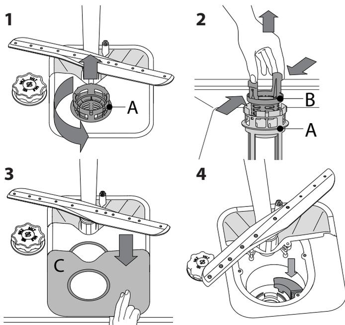
Una vez limpiados los filtros, recolóque el cuerpo de filtrado y encájelo correctamente en su sitio; esto es esencial para garantizar el funcionamiento eficiente del lavavajillas.
