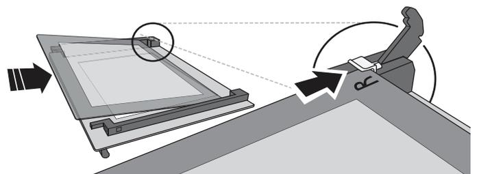
**4.** Instale novamente a extremidade superior: irá ouvir um clique, indicando que está bem posicionado. Certifique-se de que a vedação está segura antes de montar novamente a porta.
