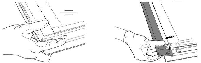
**2.** Levante e segure firmemente o vidro interior com ambas as mãos, removendo-o e colocando-o sobre uma superfície suave antes de proceder à sua limpeza.
