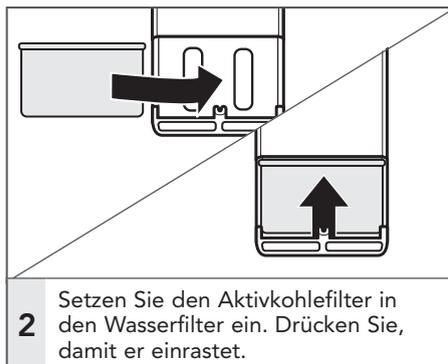
2 Setzen Sie den Aktivkohlefilter in den Wasserfilter ein. Drücken Sie, damit er einrastet.
