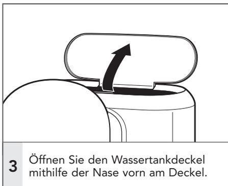
3 Öffnen Sie den Wassertankdeckel mithilfe der Nase vorn am Deckel.
