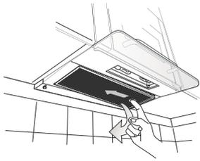
Den Fettfilter regelmäßig mit heißem Seifenwasser reinigen: Ziehen Sie den Griff nach unten, um den Filter aus der Einbaulage freizusetzen.
