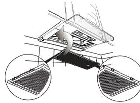
Den Fettfilter nach der Reinigung in umgekehrter Reihenfolge wieder einbauen.
