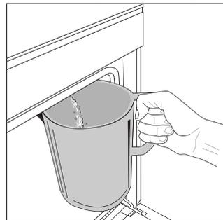
Po wybraniu funkcji „Opróżnianie” lub na żądanie z wyświetlacza uruchom funkcję i wykonaj wskazane czynności: Otworzyć drzwiczki i umieścić duże naczynie (o pojemności co najmniej 2 litrów) pod dyszą odpływową umieszczoną na dole panelu, na lewo od dyszy wlotowej. W razie potrzeby możliwe jest uruchomienie panelu sterowania w
