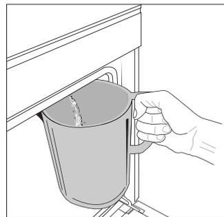
Po výběru funkce „Vypouštění“ nebo poté, co se objeví výzva na displeji, funkci spusťte a postupujte podle zobrazovaných pokynů: Otevřete dvířka a pod vypouštěcí trysku na spodní straně panelu vlevo od napouštěcí trysky umístěte velkou nádobu (o kapacitě alespoň 2 litry). V případě potřeby je
