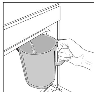
Kad ir izvēlēta funkcija "Drain" (Izlaidšana) vai displejā parādās attiecīga uzvedne, palaidiet funkciju un izpildiet tālāk norādītās darbības. Atveriet durvis un ievietojiet lielu krūzi (vismaz 2 litri) zem izlaidšanas sprauslas, kas atrodas paneļa apakšā, pa kreisi no iepildes sprauslas. Ja nepieciešams, var
