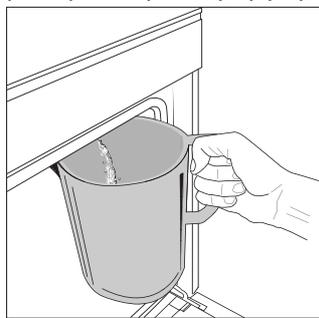
Αφού επιλεγεί η λειτουργία "Αποστράγγιση" ή όταν ζητηθεί από την οθόνη, ξεκινήστε τη λειτουργία και ακολουθήστε τις υποδεικνυόμενες ενέργειες: Ανοίξτε την πόρτα και τοποθετήστε μια μεγάλη κανάτα (χωρητικότητας τουλάχιστον 2 λίτρων) κάτω από το ακροφύσιο αποστράγγισης που βρίσκεται στο κάτω μέρος του πίνακα το
