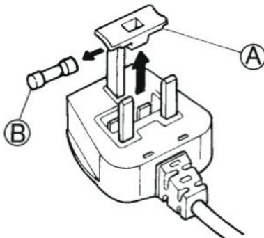
2. Die Ersatzsicherung 13 A in die Sicherungsabdeckung einlegen.
