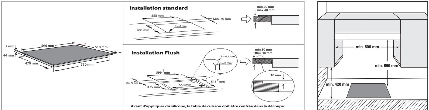
**REMARQUE:** si la distance « A » entre les éléments muraux est de 600mm à 730 mm, la hauteur « B » doit être au minimum de 530mm. Si la distance « A » entre les éléments muraux est supérieure à la largeur de la table de cuisson, la hauteur « B » doit être au minimum de 400 mm. Avant d'installer une hotte au-dessus de la table de cuisson, veuillez vous référer au manuel d'utilisation de la hotte qui spécifie les distances adéquates.
