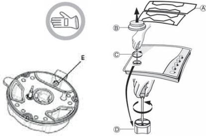
Avant d'installer la table de cuisson, n'oubliez pas de coller l'étiquette fournie avec les injecteurs contenant les informations correspondant au gaz utilisé.
