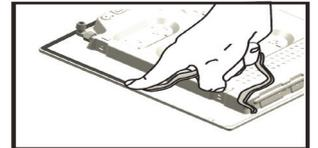
Installez la table de cuisson dans l'ouverture du plan de cuisson dont les dimensions correspondent à celles figurant dans le mode d'emploi.
