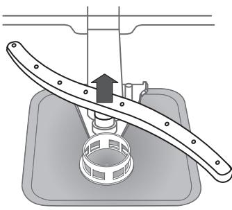
Нижнюю лопасть можно снять, потянув ее вверх.
