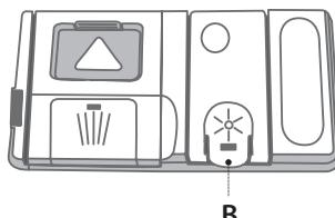
1. Откройте дозатор **B**, нажав и потянув вверх язычок крышки.
