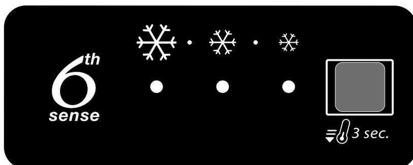
1. LEDs indicadores (apresentam a atual temperatura programada ou a função de Arrefecimento Rápido)
