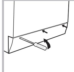
3. rimuovere il pannello di copertura sul lato anteriore della lavabiancheria con l'ausilio di un giravite (vedi figura).
