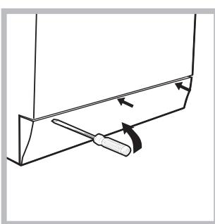
Přístup ke vstupní části čerpadla:
