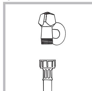
1. Conectați tubul de alimentare, însurubându-l la un robinet de apă rece cu gura filetată de 3/4 gaz (a se vedea figura).
