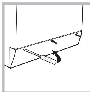
2. verificați ca nivelul de apă din mașină să fie sub marginea ușii; în caz contrar, scoateți apa în exces cu ajutorul furtunului de golire, punând-o într-un vas, după indicațiile din figura.
