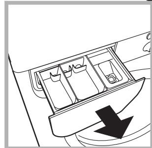
A fiók felemelésével és kifelé húzásával vegye ki a fiókot (*lásd ábra*). Folyó víz alatt mos-sa ki! Ezt a tisztítást gyakran el kell végezni.
