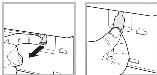
3. scoateți panoul de acoperire din partea din față a mașinii de spălat folosind o surubelnită (a se vedea figura).
