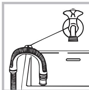
illetve akassza a mosdó vagy a kád szélére úgy, hogy a mellékelt csővezető ívet a csaphoz erősíti (*lásd ábra*). A leeresztőcső szabad végének nem szabad vízbe merülnie.
