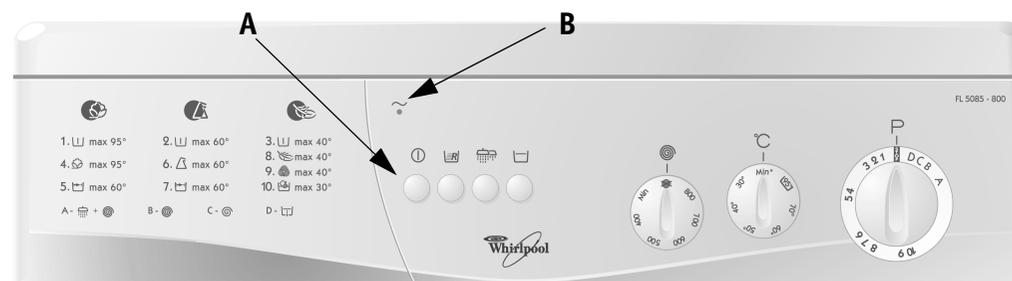
În timpul programului de spălat selecționat butonul de selectare a programului se mișcă pe etape în sensul acelor de ceasornic prin toate fazele: **prespălare, spălare principală, limpezire și centrifugare**. Fiecare etapă durează de la câteva secunde până la câteva minute.
