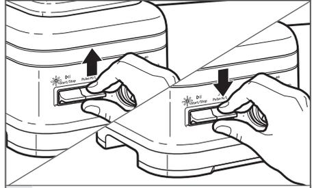
**6** Bei Bedarf können Sie die Impulsfunktion für einen kurzen Leistungsstoß beim Mixen mit Zeitvorgaben nutzen.
