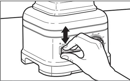
**7** Bringen Sie nach dem Mixen den Start/Stop-Schalter (▷||) in die Ausgangsstellung. Lassen Sie das Messer vollständig zum Stillstand kommen, bevor Sie den Deckel abnehmen und die gemixten Zutaten ausgießen.
