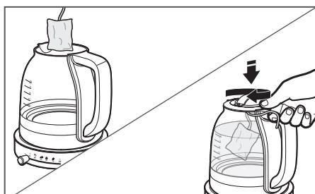
**2** **Plasser teposene direkte i glassstekokeren:** Når vannet når riktig temperatur for brygging (se bryggediagrammet), løfter du bryggekurvlokket av glassstekokeren og plasserer teposetråden over den indre kanten av kjelelokket. Deretter setter du inn og vrir bryggekurvlokket slik at tråden blir oppfangt, og senker teposen i vannet. Brygg teen som vanlig.
