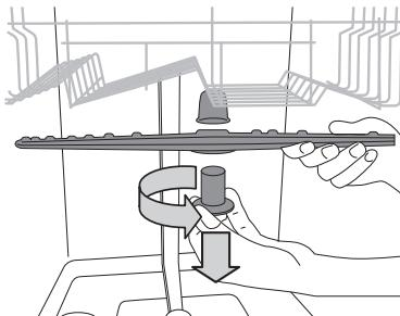
Για να αφαιρέσετε τον επάνω εκτοξευτήρα, περιστρέψτε τον πλαστικό δακτύλιο ασφάλισης αριστερόστροφα. Ο επάνω εκτοξευτήρας πρέπει να επανατοποθετείται με τρόπο ώστε η πλευρά με τις περισσότερες οπές να είναι γυρισμένη προς τα επάνω.
