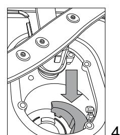
μετά τον καθαρισμό των φίλτρων, επανατοποθετήστε το φίλτρο και στερεώστε το καλά στη θέση του. Αυτό είναι σημαντικό για να διατηρείται η αποτελεσματική λειτουργία του πλυντηρίου πιάτων.
