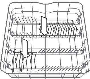
Το κάτω καλάθι διαθέτει ανακλινόμενα ράφια που μπορούν να χρησιμοποιηθούν σε κάθετη θέση όταν τακτοποιείτε πιατάκια ή σε οριζόντια θέση (χαμηλότερη) για την εύκολη τοποθέτηση τηγανιών και σαλατιέρων.
