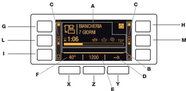
В секторе **A** отображаются иконка и выбранная программа стирки, этапы стирки и время, оставшееся до завершения цикла стирки. В секторе **B** отображаются два уровня интенсивности, соответствующие дополнительной функции ПРЕДВ. СМЕШИВАНИЕ. В секторах **C** находятся индикаторы, соответствующие доступным функциям. В секторе **D** отображается время до запуска выбранной программы, в случае если был задан ОТСРОЧКА ПУСКА.
