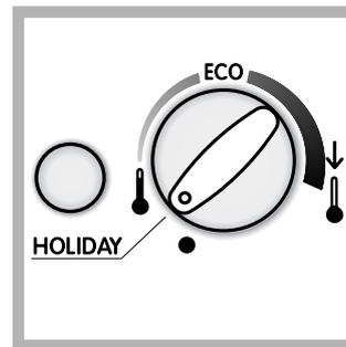
Para activar la función: coloque el mando de FUNCIONAMIENTO DEL FRIGORÍFICO en **HOLIDAY** (ver la figura). Una doble señal sonora confirmará su activación; la desactivación se indica con una sola señal sonora.
