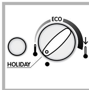
Pentru a activa funcția este necesar să: poziționați selectorul FUNCȚIONARE FRIGIDER pe **HOLIDAY** (vezi figura). Veți auzi două semnale scurte care vă vor confirma activarea funcției; dezactivarea vă va fi indicată printr-un singur semnal.
