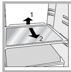
**BANDEJAS:** enteras o tipo rejilla. Son extraíbles y su altura es regulable gracias a las guías especiales (ver la figura), se utilizan para introducir recipientes o alimentos de gran tamaño. Para regular la altura no es necesario extraer las bandejas completamente.
