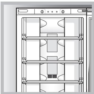
È riconoscibile dalla presenza di celle d'aerazione poste sulle pareti posteriori dei vani. Il No Frost gestisce un flusso continuo di aria fredda che raccoglie l'umidità e impedisce la formazione di ghiaccio e brina: nel vano frigorifero mantiene il giusto livello di umidità e, grazie
