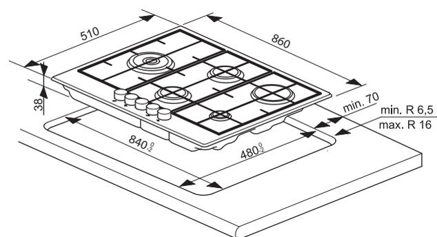
**NOTA:** qualora venga installata una cappa sopra il piano di cottura, consultare le istruzioni di montaggio della cappa nelle quali è riportata la distanza corretta da rispettare.
