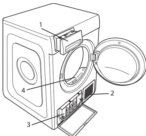
Die Filter sind wesentliche Elemente des Trockners. Sie haben die Aufgabe, die Flusen zurückzuhalten, die sich beim Trocknen bilden. Verstopfte Filter würden den Umlauf der Luft im Trockner stark beeinträchtigen: die Maschine würde mehr Zeit benötigen, mehr Strom verbrauchen und Schaden nehmen. Wenn die Filter nicht ordnungsgemäß gereinigt werden, läuft der Trockner möglicherweise nicht an.
