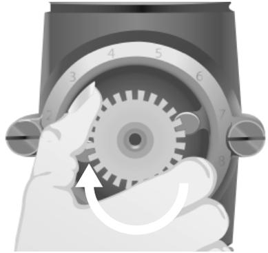
6. Quand les meules se touchent, tournez le pignon d'un « clic » ou d'un cran en arrière (dans le sens contraire des aiguilles d'une montre). Le bruit de frottement doit disparaître. Eteignez l'appareil en positionnant l'interrupteur « O/I » sur « O ». Le broyeur est désormais calibré pour fournir la mouture la plus fine possible.
