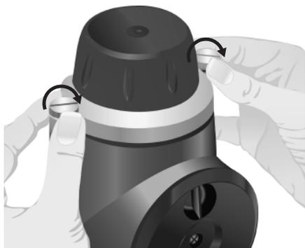
9. Lorsque les vis de verrouillage ont été serrées à la main, utilisez le tournevis à tête plate pour les bloquer.
