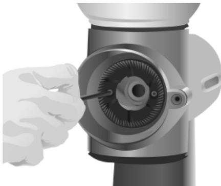
4. Mettez en place les meules de rechange sur le groupe meule/arbre et à l'intérieur du bâti moteur, en utilisant les vis de montage d'origine. Assurez-vous que les surfaces de broyage des meules sont dirigées vers l'extérieur et que les vis de montage sont bien serrées.
