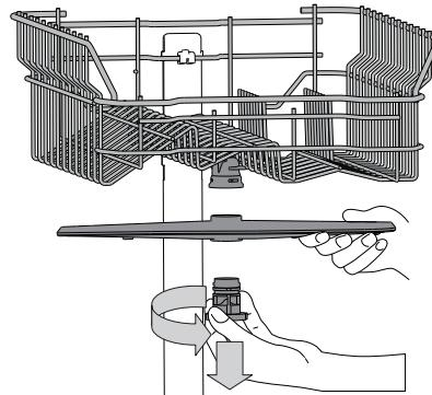
Za uklanjanje gornjeg nosača mlaznice okrenite plastični prsten za zadržavanje u smjeru suprotnom od smjera kazaljke na satu. Gornji nosač mlaznice treba se zamijeniti tako da je strana s većim brojem otvora okrenuta prema gore.
