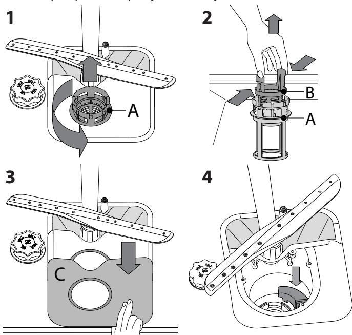
Nakon čišćenje filtara vratite sklop filtra i pravilno ga učvrstite na mjesto; to je važno za održavanje učinkovitog rada perilice suđa..
