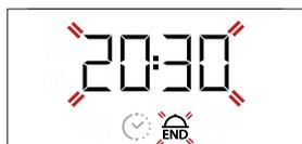
K nastavení požadovaného času ukončení přípravy použijte + nebo — a potvrzení provedte stiskem
