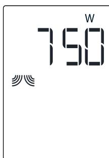
For kun at tilberede med mikrobølge, skal du trykke gentagne gange på knappen Micro (Mikro), for at vælge styrken. Brug derefter +/- knapperne til at indstille den ønskede tilberedningstid. Den længste tilberedningstid er 90 minutter.
