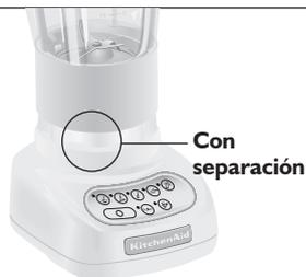
La jarra no está colocada correctamente en el collar de bloqueo, lo que impide el enganche de los acopladores. Retire la jarra de la base y colóquela correctamente en el collar. Presione hacia abajo y gire la jarra a la derecha en el collar de bloqueo hasta que oiga el segundo chasquido. Esto permitirá que la jarra enganche el acoplador. Consulte el apartado "Montaje de la licuadora".
