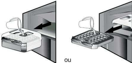
Remplacez la fabrique à glaçons dans le compartiment congélateur, ou réinsérez le plateau à glaçons dans la fabrique à glaçons. Veillez à ne pas renverser d'eau.
