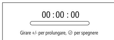
**ALLO SCADERE DEL TEMPO IMPOSTATO**, il forno emette un segnale acustico.
