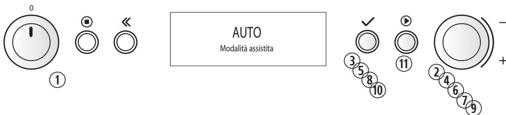
1. RUOTARE LA MANOPOLA MULTIFUNZIONE fino a visualizzare “Modalità assistita”.
