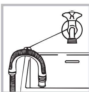
Oder hängen Sie den Ablaufschlauch in ein Becken oder eine Wanne ein; befestigen Sie ihn in diesem Falle mittels der Führung (beim Kundendienst erhältlich) an dem Wasserhahn (siehe Abbildung).
