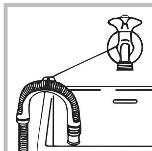
Em alternativa, apoie o tubo de descarga na beira de um lavatório ou de uma banheira, prendendo a guia (disponível para compra junto do serviço de assistência) à torneira (veja a figura). A ponta solta do tubo de descarga não deve permanecer emergida na água.
