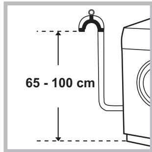
Schließen Sie den Ablaufschlauch ohne ihn dabei abzuknicken an einen geeigneten Abfluss an. Die Mindestablaufhöhe beträgt 65 - 100 cm (gemessen vom Boden), oder hängen Sie diesen mittels des Schlauchhalters gesichert in ein Becken oder Wanne ein;
