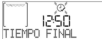
Pulse + o — para configurar la hora a la que quiere que termine la cocción y pulse ✓ para confirmar y activar la función. Coloque los alimentos en el horno y cierre la puerta: Esta función se iniciará automáticamente cuando haya transcurrido el periodo de tiempo calculado para que la cocción termine a la hora programada.
