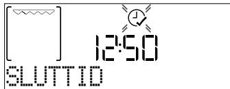
Trykk på + eller — for å stille inn tidspunktet du ønsker at tilberedningen skal avslutte, trykk deretter på ✓ for å bekrefte og aktivere denne funksjonen. Sett maten inn i ovnen og lukk døren: Funksjonen vil starte automatisk etter den tidsperioden som er beregnet for at tilberedningen skal være ferdig på det tidspunktet du har angitt.
