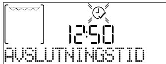
Tryck på + eller - för att ställa in avslutningstiden och tryck sedan på ✓ för att bekräfta och aktivera funktionen. Sätt in maten i ugnen och stäng luckan: Funktionen startar automatiskt efter den tid som har beräknats för att tillagningen ska vara klar vid inställd tid.
