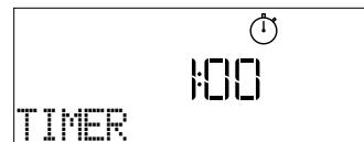
Når minuturet er aktiveret kan man også markere og aktivere en funktion. Tryk på **▷** for at tænde for ovnen, og vælg herefter den ønskede funktion.
