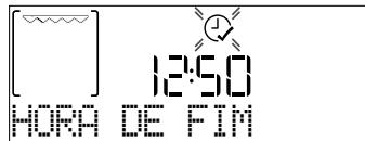
Prima + ou — para definir o final pretendido da cozedura e, em seguida, prima ✓ para confirmar e ativar a função. Coloque os alimentos no forno e feche a porta: A função inicia-se automaticamente após o período de tempo calculado para concluir a cozedura à hora programada.
