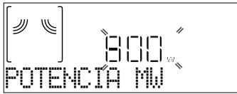
Cuando el valor parpadee en la pantalla, pulse + o — para cambiarlo, después pulse ✓ para confirmar y siga con los ajustes siguientes (si es posible).
