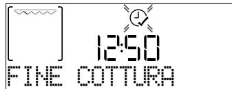
Premere + o — per impostare l'ora di fine cottura desiderata, quindi premere ✓ per confermare e attivare la funzione. Inserire il cibo nel forno e chiudere la porta: la funzione si avvierà automaticamente dopo un periodo di tempo calcolato per terminare la cottura all'orario impostato.
