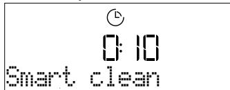
Pulse **▷** para activar la función de limpieza: la pantalla le indicará una secuencia de acciones que deberá llevar a cabo antes de iniciar la limpieza. Pulse **✓** en cualquier momento cuando termine.
