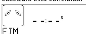
Prima ▶ para continuar no modo manual, adicionando mais tempo em passos de 30 segundos (com as funções que utilizam micro-ondas) ou 5 minutos (sem micro-ondas) ou prima + para prolongar o tempo de cozedura, definindo uma nova duração. Em ambos os casos, os parâmetros de cozedura serão retomados.
