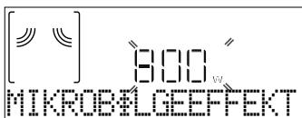
Når værdien blinker på displayet anvendes + eller – til at ændre den, hvorefter man trykker på ✓, for at bekræfte, og fortsætte med at ændre den efterfølgende indstilling (hvis dette er muligt).
