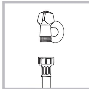
1. Reliez le tuyau d'alimentation en le vissant à un robinet d'eau froide à embout fileté 3/4 (voir figure).
