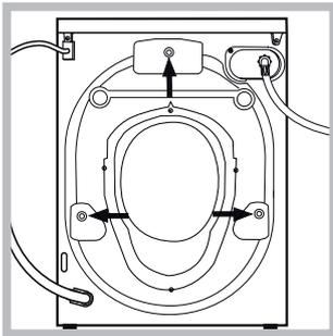
3. Die 3 Transportschutzschrauben herausschrauben und die an der Gerätrückwand befindlichen Distanzstücke aus Gummi entfernen (siehe Abbildung).
