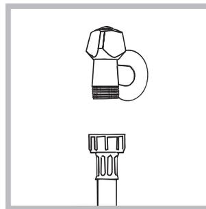
1. Realize a ligação do tubo de alimentação parafusando-o a uma torneira de água fria com bocal de rosca de 3/4 (veja a figura). Antes de realizar esta ligação, deixe a água escorrer até estar límpida.
