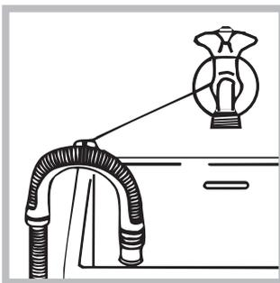
Oder hängen Sie den Ablaufschlauch in ein Becken oder eine Wanne ein; befestigen Sie ihn in diesem Falle mittels der Führung (beim Kundendienst erhältlich) an dem Wasserhahn (siehe Abbildung). Das freie Ablaufschlau-
