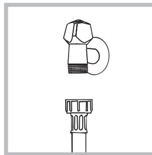
1. Schrauben Sie den Wasserschlauch an einen Kaltwasserhahn mit  $\frac{3}{4}$ -Gewindeanschluss an (siehe Abb.). Lassen Sie das Wasser vor dem Anschluss so lange auslaufen, bis klares Wasser austritt.
