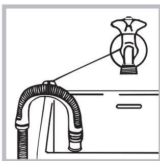
Autrement, accrocher le tuyau de vidange à un évier ou à une baignoire, dans ce cas, attacher la crose (à acheter au service d'assistance) au robinet (voir figure). L'extrémité libre du tuyau d'évacuation ne doit pas être plongée dans
