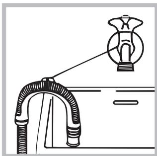
Em alternativa, apoie o tubo de descarga na beira de um lavatório ou de uma banheira, prendendo a guia (disponível para compra junto do serviço de assistência) à torneira (veja a figura). A ponta solta do tubo de descarga não deve
