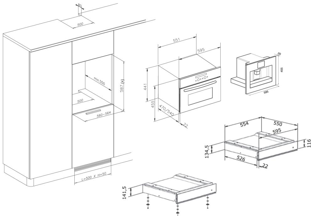
( \*) Bei einer Schrankhöhe von 595 muss die Wärmeschublade mit den 4 Füßen und jeweils 1 mm Unterlegscheiben werden (in der Verpackung enthalten) im unteren Teil installiert werden.
