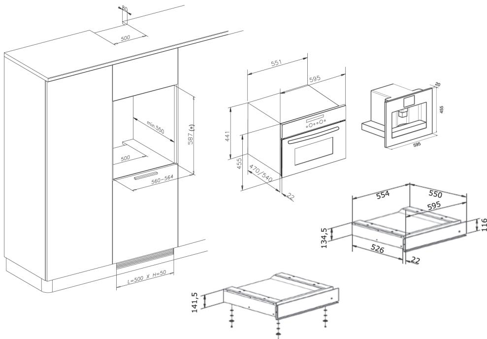
(\*) V případě výšky výklenku pro skříňku 595 je nutné instalovat zásuvku se 4 nožičkami a odpovídajícími 1mm podložkami (součástí balení) ve spodní části.
