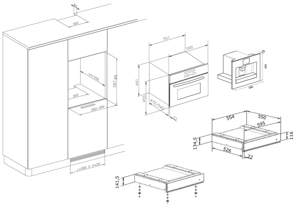
( \*) V prípade výšky výklenku linky s výškou 595 sa zásuvka musí nainštalovať so 4 nožičkami a s príslušnými 1 mm podložkami (súčasť balenia) v spodnej časti.
