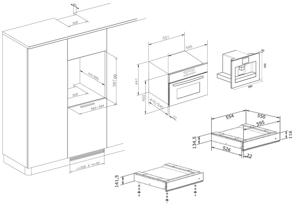
(\*) У випадку висоти 595 ніші в меблях, шухляду слід встановлювати з 4 ніжками і відповідними 1 мм шайбами (постачаються в комплекті) в нижній частині.
