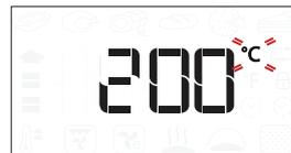
Cuando el icono °C/°F parpadee en la pantalla, gire el selector para cambiar el valor y después pulse para confirmar y continuar con la modificación de ajustes siguiente (si es posible). También se puede ajustar el nivel del grill (3 = alto, 2 = medio, 1 = bajo) al mismo tiempo.
