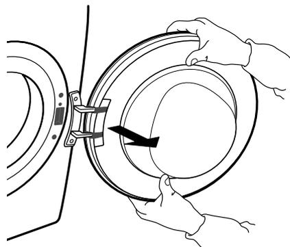
**5.** Fixe a porta do lado esquerdo, rodando os 2 parafusos. Certifique-se de que aperta os parafusos na vertical para evitar a compressão para fora do vedante da porta.
