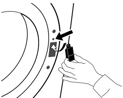
**7.** Fixe os 2 parafusos existentes por cima e por baixo do sistema de trinco da porta.
