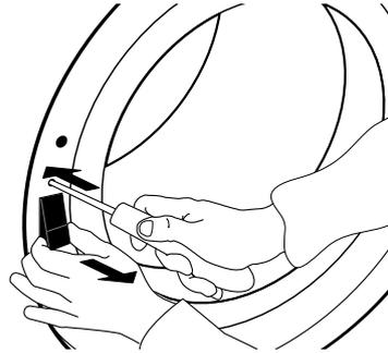
**4.** Remova os 2 parafusos existentes na dobradiça da porta e retire a mesma.
