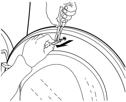
**2.** Desaperte os 2 parafusos existentes por cima e por baixo do sistema de trinco da porta.
