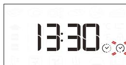
Tarpeen vaatiessa aseta kypsennyksen haluttu päättymisaika nuppia kääntämällä, vahvista sitten painamalla ja käynnistä toiminto. Laita ruoka uuniin ja sulje luukku: Toiminto käynnistyy automaattisesti sen jälkeen, kun on kulunut laskettu aika, joka tarvitaan siihen, että kypsennys päättyy asetettuna ajankohtana.
