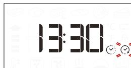
Drej om nødvendigt på knappen, for at indstille tilberedningens ønskede afslutningstidspunkt, og tryk herefter på , for at bekræfte og starte funktionen. Sæt retten i ovnen og luk lågen: Funktionen starter automatisk efter den beregnede periode for at tilberedningen slutter på det tidspunkt, du har indstillet.
