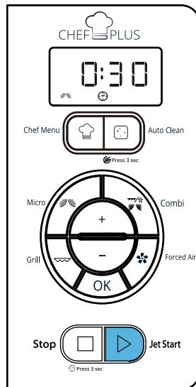
Diese Funktion setzt beim Drücken der Taste "Jet Start (Jetstart)" die Mikrowellenfunktion 30 Sekunden lang mit maximaler Leistung (800 W) in Betrieb. Dies wird für ein schnelles Aufwärmen von Speisen mit hohem Wassergehalt oder Getränken empfohlen, z. B. klare Suppen, Kaffee oder Tee.
