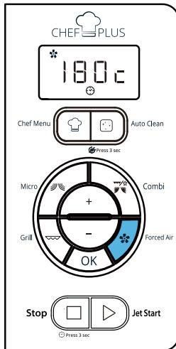
Mit dieser Funktion erhalten Sie Gerichte wie aus dem Ofen. Mit einem leistungsstarken Heizelement und einem Gebläse entspricht der Backvorgang dem eines traditionellen Backofens. Verwenden Sie diese Funktion für Schaumgebäck, Backwaren, Kuchen, Soufflés, Geflügel und Braten.
