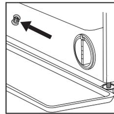
Retire a tampa da "mangueira de drenagem de emergência" da extremidade da mangueira e deixe a água sair para dentro do recipiente.
