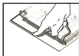
Для крепления варочной панели используйте скобы (A), входящие в комплект поставки. Вставьте скобы в соответствующие отверстия (они обозначены стрелкой) и закрепите их винтами в соответствии с толщиной столешницы (см. рисунки ниже).
