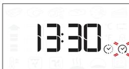
Draai eventueel aan de knop om de gewenste eindtijd van de bereiding in te stellen en druk dan op om te bevestigen en de functie te starten. Zet het voedsel in de oven en sluit de deur: De functie start automatisch na een tijdsperiode die berekend is om de bereiding te laten eindigen op het uur dat u gekozen hebt.
