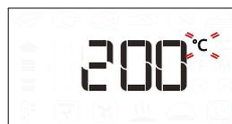
Keď na displeji blika ikonka °C/°F, otáčaním gombíka zmeňte hodnotu, potvrdte stlačením a pokračujte zmenou ďalších nastavení (ak je to možné).
