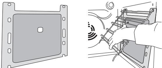
För bästa bruk av de katalytiska panelernas självrengörande egenskaper rekommenderar vi att värma ugnen till 200°C i ungefär en timme med funktionen "Över/underv.& fläkt". Ugnen ska vara tom när detta görs.
