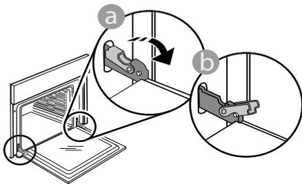
Vrata boste lahko povsem preprosto demontirali, če jih še naprej zapirate in jih istočasno nekoliko vlečete navzgor, dokler se ne sprostijo iz vpetja. Odložite vrata na stran in na mehko površino.
