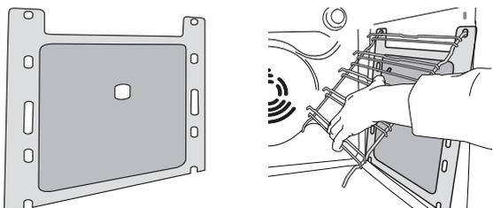
For å utnytte de selvrensende egenskapene til de katalytiske panelene best mulig, anbefaler vi å varme opp ovnen til 200 °C i omtrent en time med "Over/Undervarme"-funksjonen. I løpet av denne tiden må ovnen være tom.
