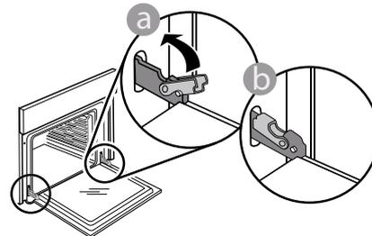
Z nežnim pritiskom preverite, ali sta zaporna vzvoda v pravilnem položaju.
