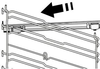
Замкніть верхній затискач телескопічної напрямної на напрямній для решітки та просуньте його вздовж напрямної до упору. Опустіть на місце інший затискач.
