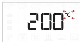
Când pictograma °C/°F clipește pe afișaj, rotiți butonul pentru modificarea valorii, apoi apăsați pentru confirmare și continuați să modificați următoarele setări (dacă este posibil).
