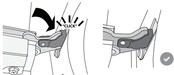
5. Testa att stänga luckan och kontrollera att den är i linje med kontrollpanelen. Om den inte är det, upprepa stegen ovan: Dörren kan skadas om den inte fungerar som den ska.
