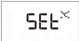
Otočením voliaceho gombíka vyberte jednotku merania a potom potvrdte stlačením
