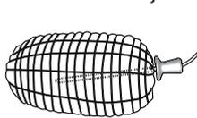
Poziționarea corectă a sondei este extrem de importantă pentru obținerea unor rezultate de preparare perfecte. Introduceți complet sonda în carne, evitând zonele osoase și părțile cu grăsime. Pentru carnea de pasăre, sonda trebuie introdusă pe diagonală, în partea din mijloc a pieptului, având grijă ca vârful să nu ajungă într-o porțiune goală. Dacă gătiți o bucată de carne cu grosime neregulată,
