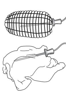
De correcte plaatsing van de thermometer is belangrijk om het gewenste bereidingsresultaat te kunnen bereiken. Steek de thermometer volledig in het malste gedeelte van het stuk vlees, zonder daarbij botten of vette gedeeltes te raken.
