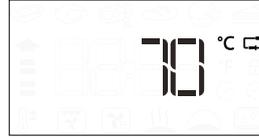
Pritisnite da biste započeli postavke. Okrenite dugme da biste podesili željenu temperaturu sonde za meso. Pritisnite da biste potvrdili. Okrenite dugme da biste podesili temperaturu unutrašnjosti rerne.
