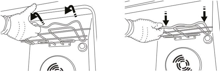
3. Para reposicionar a resistência, levante-a, puxando ligeiramente na sua direção, e certifique-se de que fica assente nos suportes laterais.
