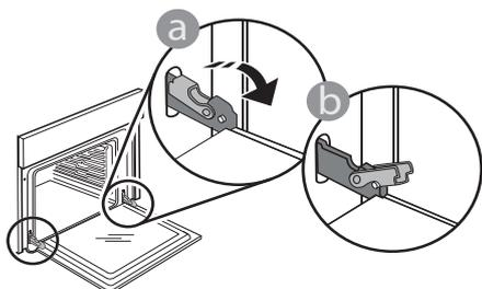
Demontați pur și simplu ușa, continuând să o închideți și trăgând-o în sus în același timp, până când se eliberează din locaș. Lăsați ușa deoparte, sprijinită pe o suprafață moale.
