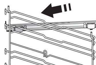
Cuplați clema superioară a șinei pe ghidajul pentru grătar și culisați-o până la capăt. Coborâți și cealaltă clemă în poziție.
