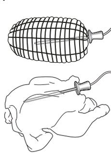
Precízne umiestnenie sondy je veľmi dôležité na dosiahnutie bezchybných výsledkov pečenia. Sondu zapichnete do časti, kde sa nachádza najviac mäsa. Vyhýbajte sa kostiam a častiam s tukom. Pri hydine sa sonda vkladá z boku do stredu prs, tak aby sa špička sondy nedostala do dutej časti. Ak má mäso rôznu hrúbku, pred vybratím z rúry skontrolujte, či sa upieklo rovnomerne. Koniec sondy pripojte do otvoru na pravej strane priestoru rúry.
