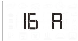
Otočením voliaceho gombíka vyberte menovitý prúd a potom potvrdte stlačením
