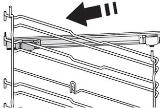
Fäst den rörliga skenans övre klämman på sidostegen och låt den glida så långt som möjligt. Sänk ner den andra klämman på plats.
