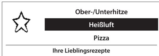
^ oder v zur Auswahl der Funktion verwenden, durch Drücken von . OK select bestätigen und anschließend ▷ zur Aktivierung drücken.
