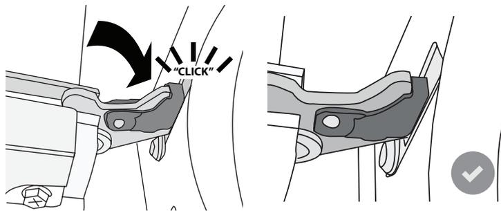
**6.** Versuchen, die Tür zu schließen und sicherstellen, dass sie auf das Bedienfeld ausgerichtet ist. Ist dies nicht der Fall, die oben aufgeführten Schritte wiederholen: Die Tür könnte beschädigt werden, wenn dies nicht richtig funktioniert.
