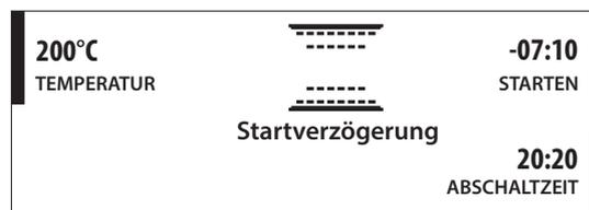
Zur unmittelbaren Aktivierung der Funktion, die programmierte Zeitverzögerung löschen und
