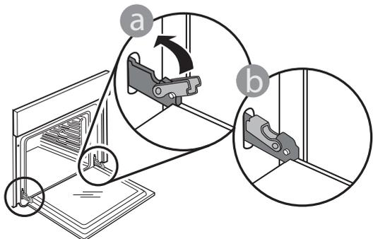
**5.** Einen leichten Druck ausüben, um zu überprüfen, dass sich die Haken in der korrekten Position befinden.
