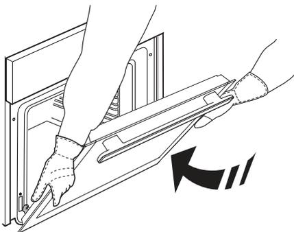
**3.** Die Tür senken und anschließend vollständig öffnen.
