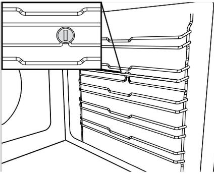
**2.** Entfernen Sie die beiden Schrauben mit Hilfe einer Münze oder eines Schraubenziehers.
